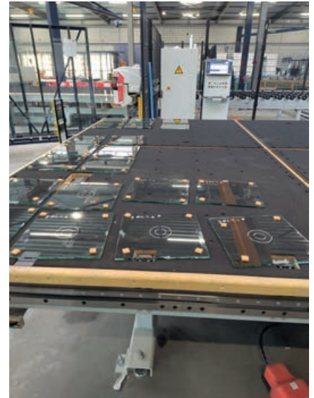
▲ Het glas is voor het onderzoek bij GSF gescand om te kijken waar zich eventuele krasjes bevinden en die te markeren.
