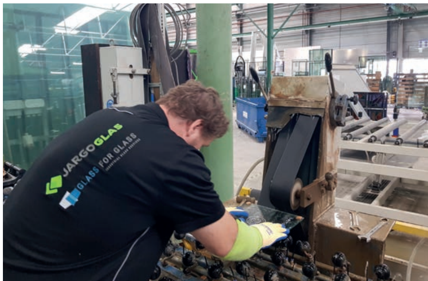
▲ De proefstukken zijn bij Jargo Glas afgescherpt en gehard.
