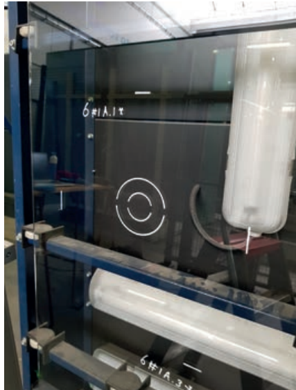
▲ Het glas is voor het onderzoek bij GSF gescand om te kijken waar zich eventuele krasjes bevinden en die te markeren.
