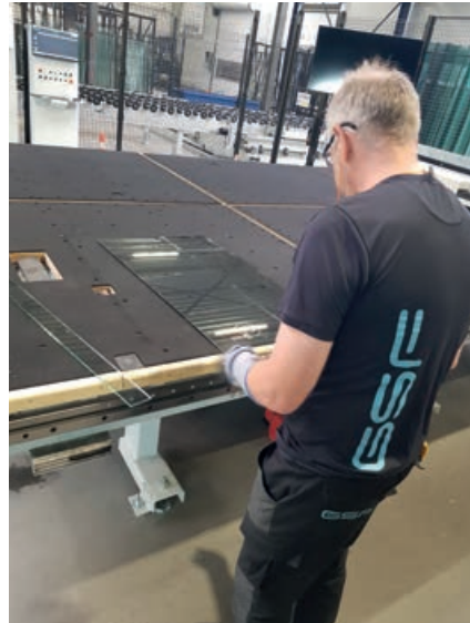
▲ Het glas is voor het onderzoek bij GSF gescand om te kijken waar zich eventuele krasjes bevinden en die te markeren.
